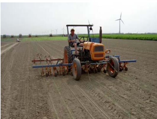
Winnaar Steeghs in zaaiui met een nauwkeurig gestuurde schoffel met vinger en torsiewieders
