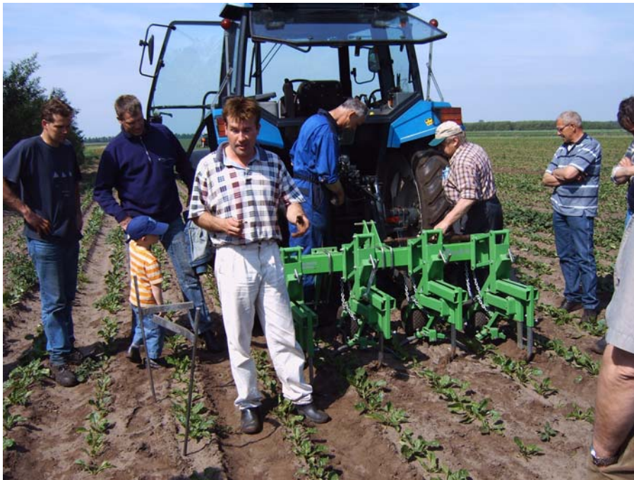
Foto 4 De Rosko gewasgeleideschoffel is vooral voor toepassing in maïs ontwikkeld, maar voldoet ook in suikerbieten; het is een eenvoudig en onderhoudsarm werktuig
