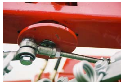
Foto 4 Aandrijving veertanden Bio-Wieder
