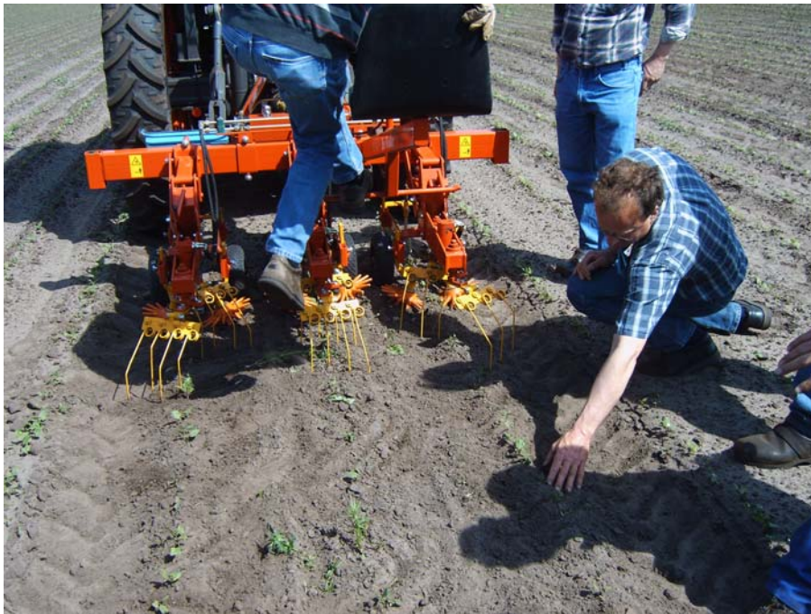
Foto 5 De Bio-Wieder hier nog als prototype; de veertanden werken met een heen- en weergaande beweging kleine onkruiden uit de rij
