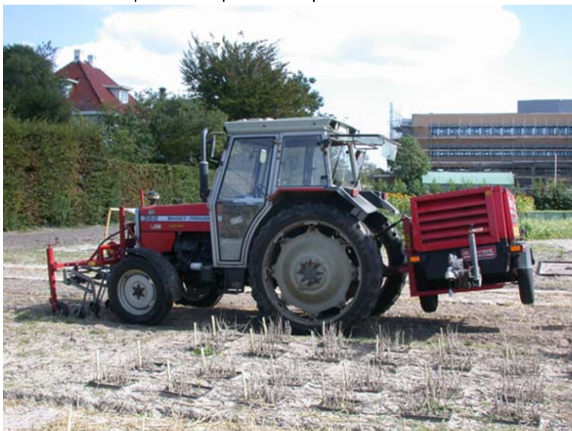
Foto 3: Pneumat voorop en dieselcompressor achterop de trekker
