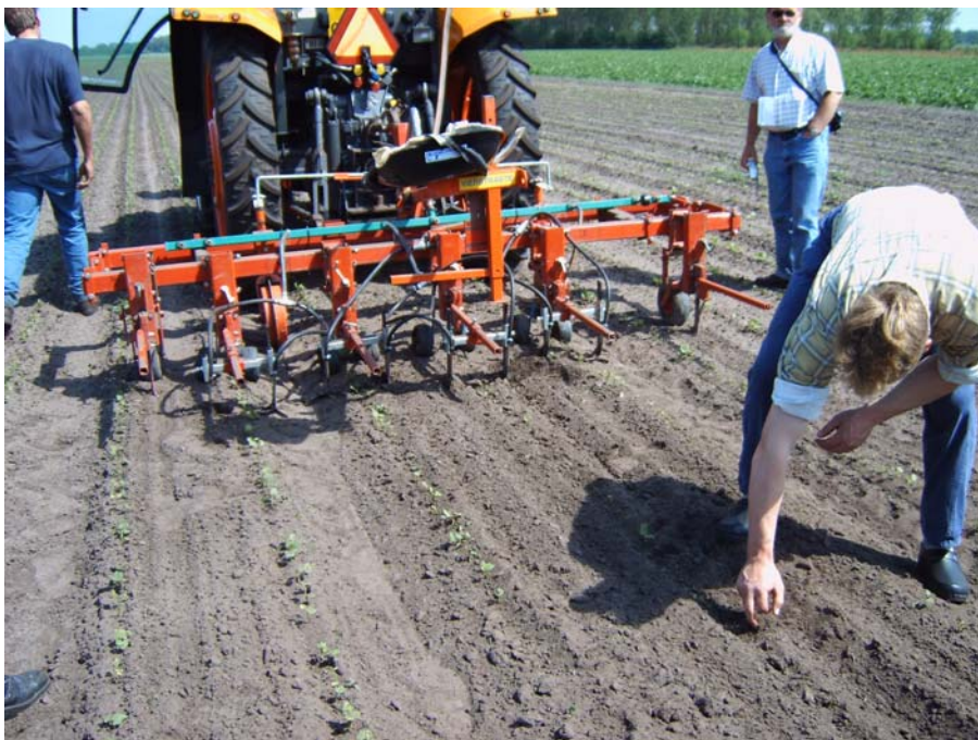
Foto 3 De Pneumat Onkruidblazer gaf in stamslabonen geen gewasschade te zien
