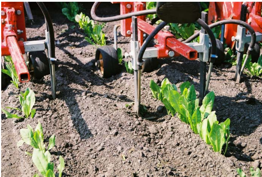
Foto 7 De Pneumat Onkruidblazer in cichorei bestreed alle kleine onkruiden in de gewasrij
