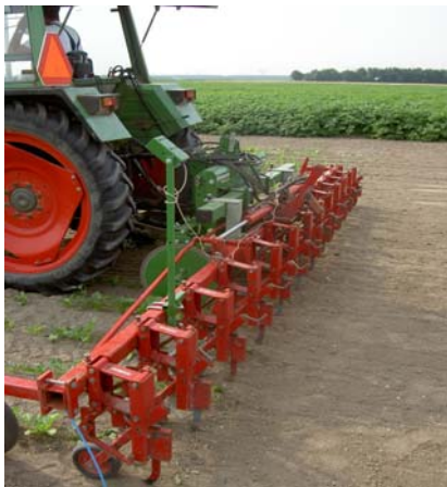
Deelnemer Broekemahoeve met cameragestuurde schoffel (Robocrop) in
