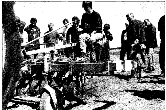
Een schoffel met Pneumat. Een blazer blaast met 5 atmosfeer druk onkruiden uit de rij. De schoffel buldozert te veel.
