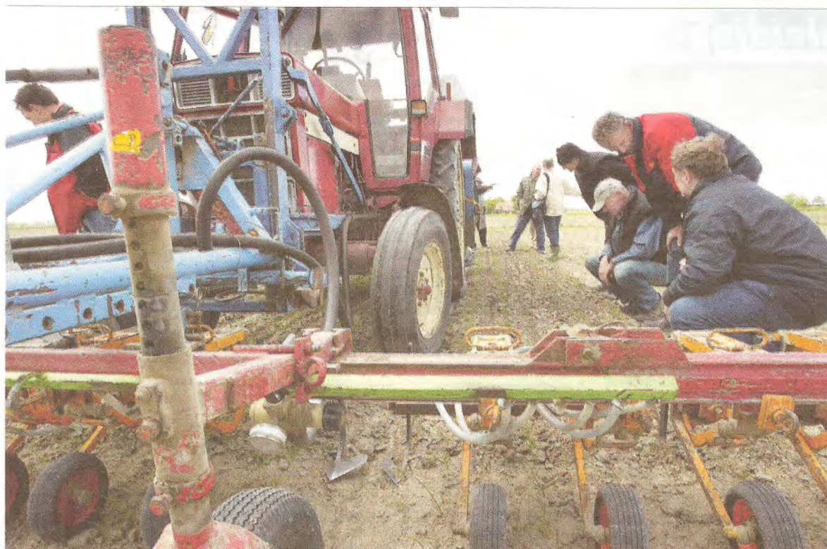
DEMONSTRATIE - Bezoekers aan een onkruidbestrijdingdemonstratie in suikerbieten en zaaiuien bij akkerbouwer Miedema in Oudebildtzijl bekijken aandachtig de constructie van de pneumat. Met de machine wordt onkruid bestreden door middel van luchtdruk. De machine blijkt zeer geschikt voor onkruidbestrijding in de gewasrij. De demonstratie vond plaats in het kader van het project Mechanisch Schoon. Foto: Roelof Stroetinga.
