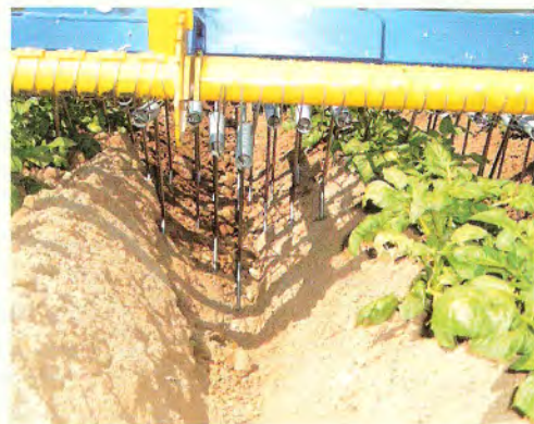
De Treffler wiedege is ook in te zetten in ruggenteelt. Zowel op de top van de rug, op de flanken als onderin de rug is er dezelfde tanddruk.
